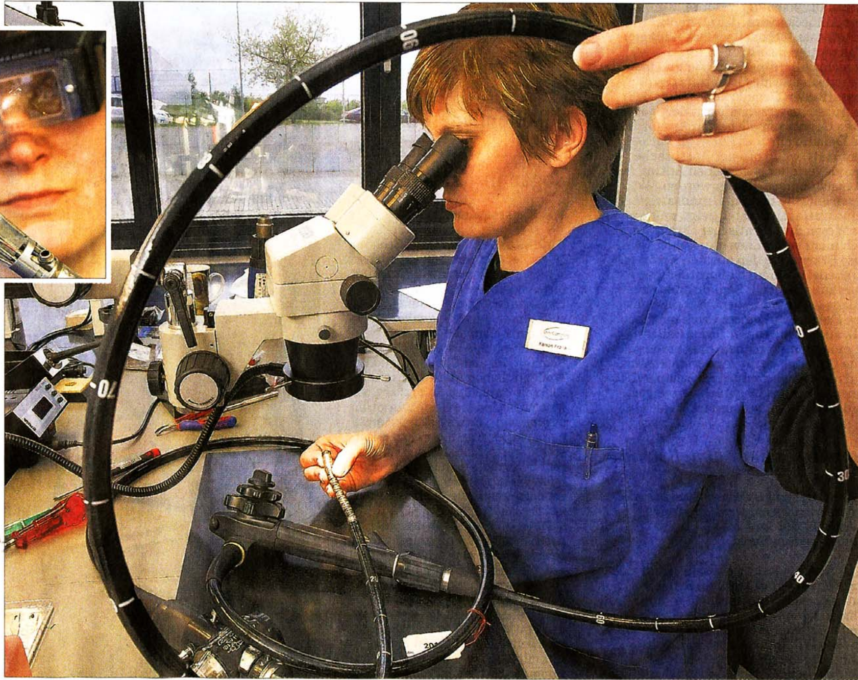
Kerstin Franke prüft mit Hilfe eines Mikroskops ein Endoskop, um es zu warten. In dem Unternehmen müssen dank moderner Technik nicht ganze Komponenten getauscht werden. Fotos (2): JENS BÜTTNER / DPA
